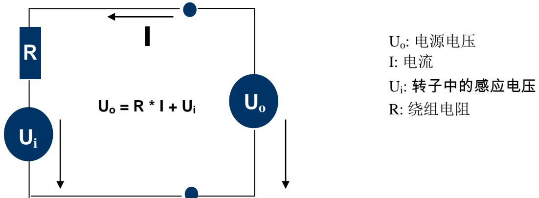
转子中的感应电压与转子的角速度成正比
