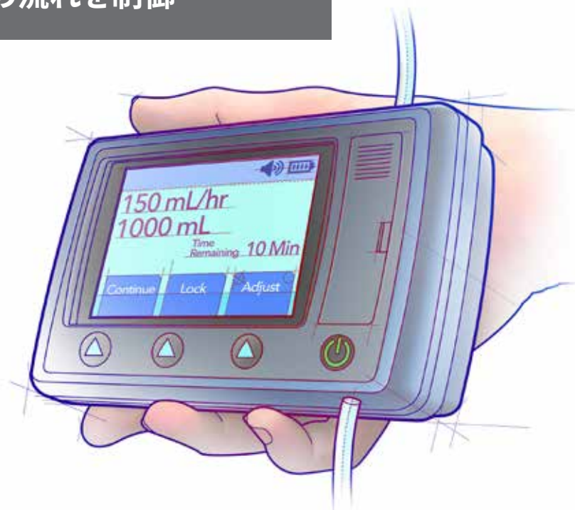
小型のモーションコントロールシステムで駆動する経腸栄養注入ポンプ
