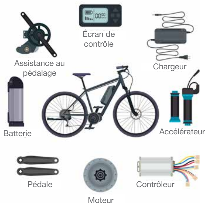
Schéma 1 : Composants des vélos électriques
