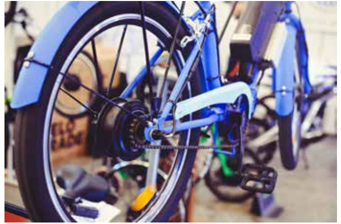
Schéma 2 : Moteur central intégré dans le pédalier (à gauche) ; moteur moyeu intégré dans la roue arrière du vélo (à droite)
