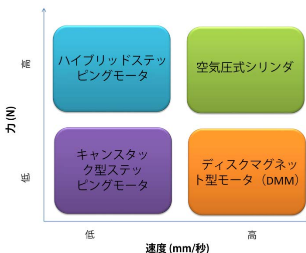
図 1 - このブロック行列は、さまざまな速度での揚荷能力に基づいたリニアアクチュエータの広い分類を示しています。
