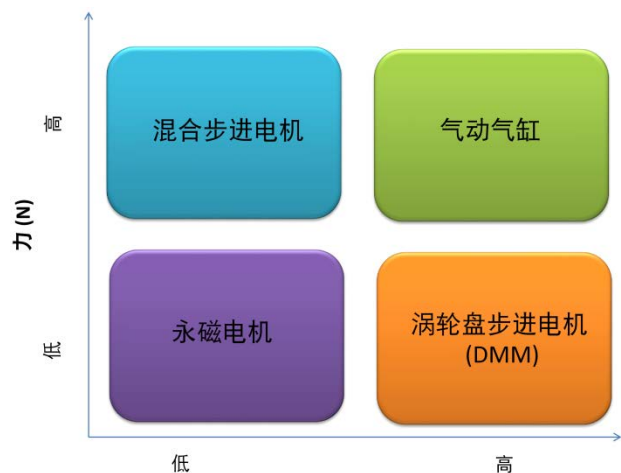
图 1 - 此矩阵显示了基于各种速度下荷载能力的直线执行器广泛分类。
